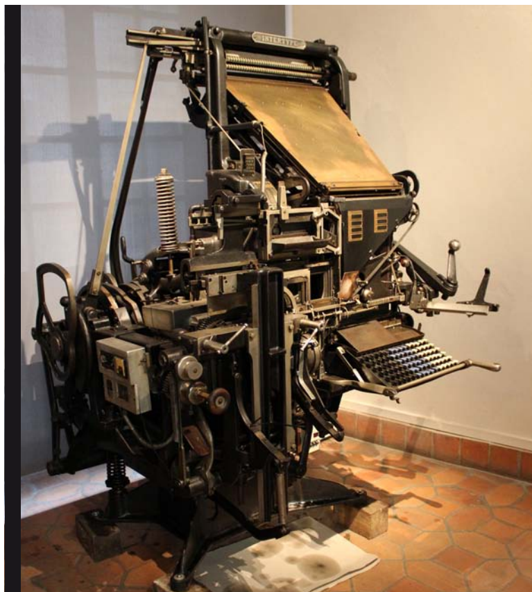
Macchina per la composizione di linee di blocco del tipo Intertype, 1930.
