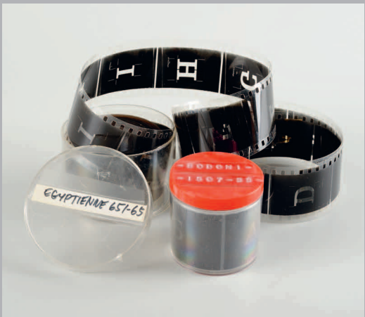
Microfilm des phototypes d'un caractère dessiné par Ladislav Mandel pour la société Lumitype
